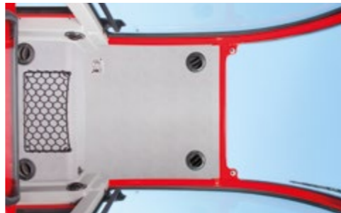
Die Klimaanlage baut auf einer leistungsfähigen Anlage mit dem umweltfreundlichen Kühlmittel R134A auf. Damit kann die Kabine auch bei niedriger Motordrehzahl gekühlt werden; die Heizung arbeitet mit einem Wärmetauscher.
