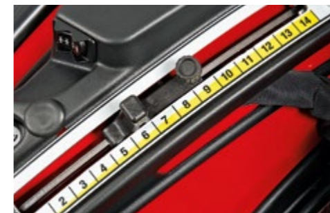
KRAFTHEBER MIT ZUGKRAFT- UND LAGEREGELUNG Vorrichtung mit gemischter Regelung.
