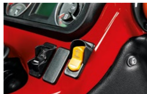
BEDIENELEMENT FÜR DIE AUFRECHTERHALTUNG DER ZAPFWELLE Bedienelement für die Aufrechterhaltung der Zapfwelleneinschaltung auch bei nicht an Bord befindlichem Fahrer.
