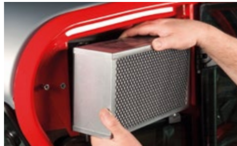
Groß bemessene Filter, zwecks ordentlicher Wartung leicht zugänglich.
