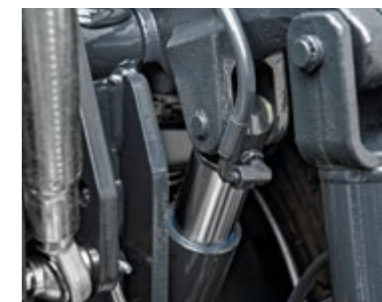
HYDRAULISCHE AUFHÄNGUNG Hydraulische Aufhängung auf dem hinteren Kraftheber UNIFLEX.
