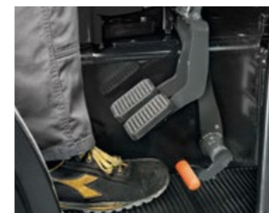
HEBEL DER ZAPFWELLE Dieses Bedienelement schaltet die Zapfwelle im unabhängigen oder synchronisierten Modus ein.
