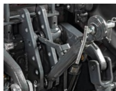
ERHÖHTER OBERLENKER Dank dieser Hubgeometrie wird die Einstellung der Arbeitsgeräte erleichtert.
