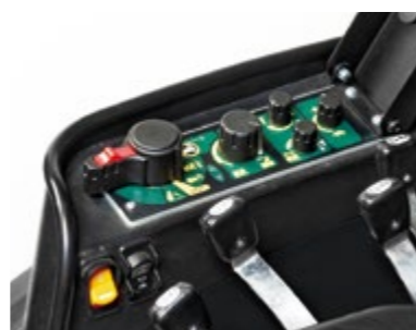
ELEKTRONISCHER KRAFTHEBER Beim Einsatz eingezogener Anbaugeräte gewährleistet die elektronische Zugkraftregelung bessere Leistungen und Präzision.
