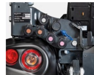
HYDRAULIKANLAGE Hydraulikanlage mit elektro-proportionalem Joystick Steuerung mit Doppel Sicherheitssystem des Bedieners und integriertem Aggregat mit Konfiguration und Einstellungen anpassbar - 12 Schnellanschlüssen hinten - Häusere Krafthebersteuerung.
