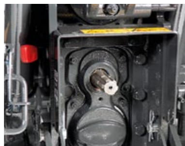
ZAPFWELLE • Hintere Zapfwelle 540-1000 U/min • Hintere Zapfwelle 540-540S U/min
