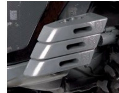
VORDERE BALLASTELEMENTE Sie stehen nicht über die Fahrzeugabmessungen hervor, der Radstand und die Abmessungen des Traktors bleiben unverändert.
