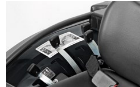
KRAFTHEBER 2 doppelwirkende Steuerventile und 1 einfachwirkendes Steuerventil + 1 Steckkupplung hinten für Ölrücklauf.
