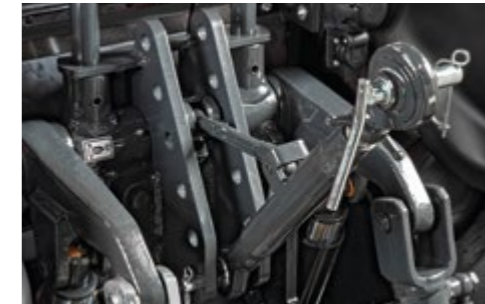
ERHÖHTER OBERLENKER* Dank dieser Hubgeometrie wird die Einstellung der Arbeitsgeräte erleichtert.
