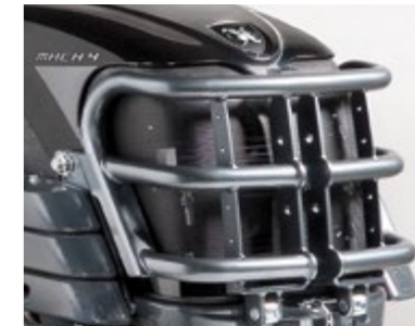
BULLBAR Fahrzeugbauteil aus Stahlrohr zum Schutz der vorderen Karosserie; darin eingelassen sind der 3. Anbaupunkt bei Fahrzeugausstattung mit vorderem Kraftheber.
