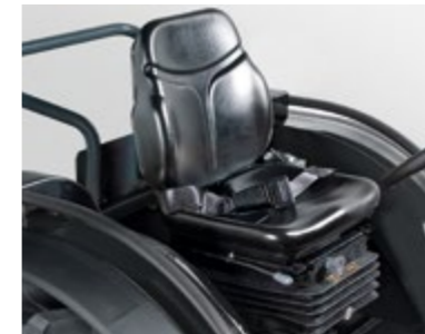
PNEUMATISCHER SITZ Sitz der letzten Generation mit Luftfederung.
