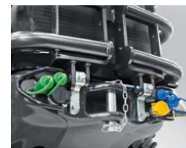
VORDERE SCHNELLANSCHLÜSSE Vorderer Kraftheber > 6 gleiche Anschlüsse wie hinten, davon 2 doppelwirkende + 1 mit elektronisch geregeltem Dauerzufluss und 1 einwirkender.
