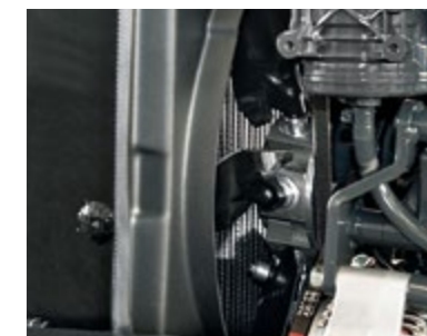
LÜFTERRAD ACS Motorlüfter mit Gegenstromprinzip ACS (Air Clean System). Verringert den Reinigungsaufwand des Kühlgitters und sorgt für eine konstante Kühlung des Motors.
