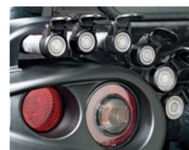
HINTERE SCHNELLANSCHLÜSSE MIT EBENER STIRNSEITE Schneller Anschluss; sauber und ohne Ölverluste.
