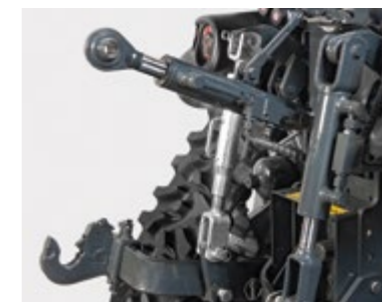
SENKRECHTE ZUGSTANGE UND DRITTER PUNKT Optimiert die Positionierung und Neigung der Anbaugeräte.
