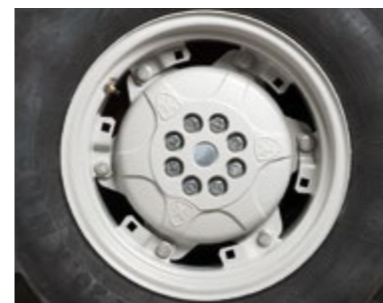
HINTERE GUSSEISEN-FLANSCH Mit sechs Anschlüssen zur Balancierung der Maschine.
