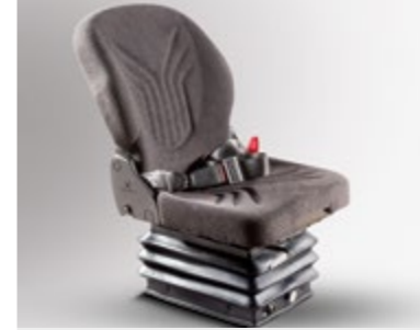
GRAMMER-STOFFSITZ Pneumatischer Federung mit zurückklappbarer Rückenlehne und Lendenregelung.
