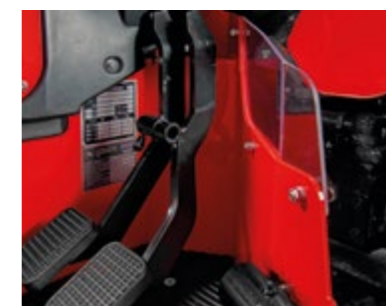
STAUBSCHUTZ Schützt den Fahrer von Staub, Zweigen etc...
