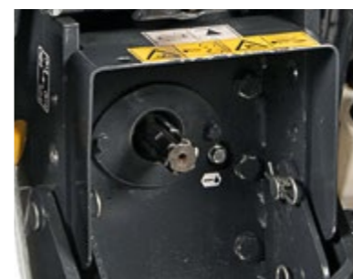
ZAPFWELLE Getriebe mit Heckzapfwelle 540/1000 U/min
