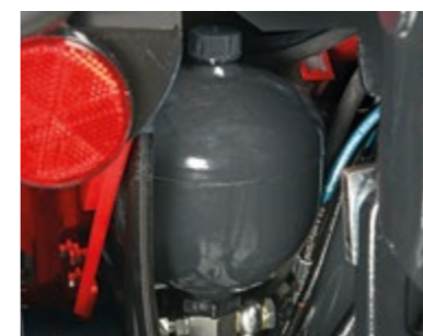
DUMPING Dämpft die von den Anbaugeräten eingeleiteten Schwingungen, erhöht somit den Komfort und schützt Maschine sowie Fahrer vor möglichen Schäden.
