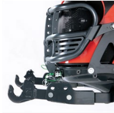
FRONTKRAFTHEBER* Hilfsvorrichtung mit verstellbaren Unterlenkern und Schnellkupplungen komplett mit Bullbar. Der Frontkraftheber ermöglicht das Arbeiten in Kombination mit der Heckausrüstung.
