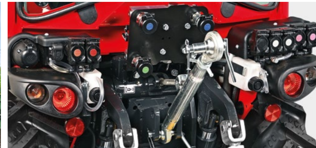
HYDRAULIKANLAGE Modulare Hydraulikanlage mit maximal 11 Hydraulikkupplungen für kontinuierlichen Durchfluss, doppeltwirkende Anschlüsse und freien Rücklauf. Alle Anschlüsse werden von Hydraulikleitungen großen Querschnitts versorgt, um Druckverluste zu vermeiden und die Effizienz der Anlage zu steigern.
