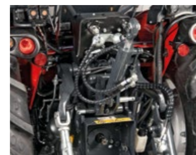
HYDRAULISCHE HUBSTREBE UND OBERLENKER Optimiert Position und Neigung der Anbaugeräte.
