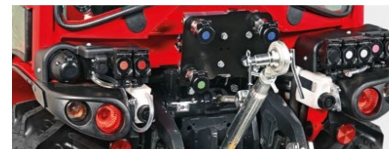
SCHNELLKUPPLUNGEN HINTEN Modulare Hydraulikanlage mit maximal 11 Hydraulikkupplungen für kontinuierlichen Durchfluss, doppelwirkende Anschlüsse und freien Rücklauf. Alle Anschlüsse werden von Hydraulikleitungen großen Querschnitts versorgt, um Druckverluste zu vermeiden und die Effizienz der Anlage zu steigern.
