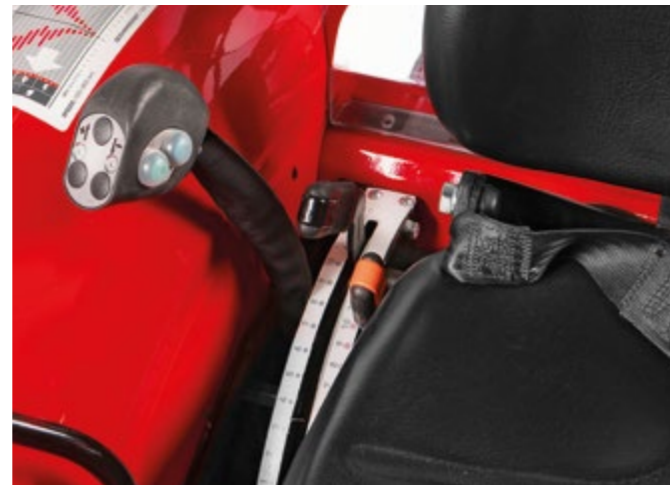
KRAFTHEBER MIT ZUGKRAFT- UND LAGEREGELUNG Die Vorrichtung für die optimale Lage- und Zugkraftregelung des Geräts garantiert höchste Arbeitspräzision bei maximaler Bodenhaftung und Traktion des Traktors.
