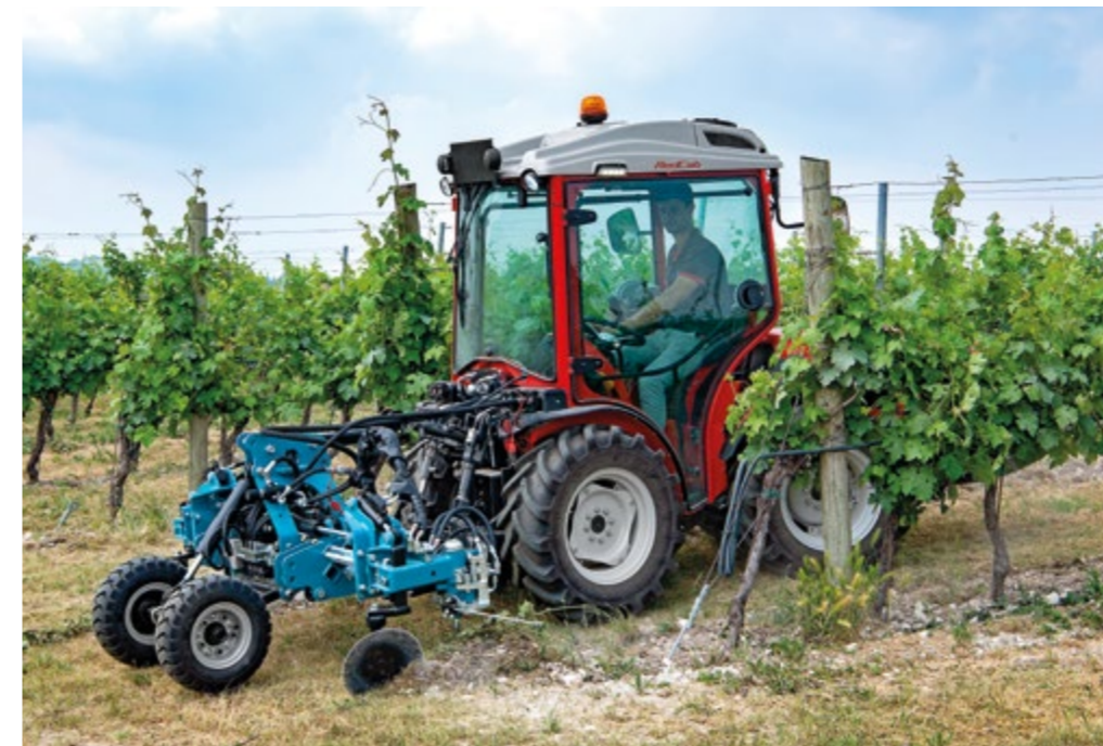
FRONTKRAFTHEBER* Hilfsvorrichtung mit verstellbaren Unterlenkern und Schnellkupplungen komplett mit Bullbar. Der Frontkraftheber ermöglicht das Arbeiten in Kombination mit der Heckausrüstung.
