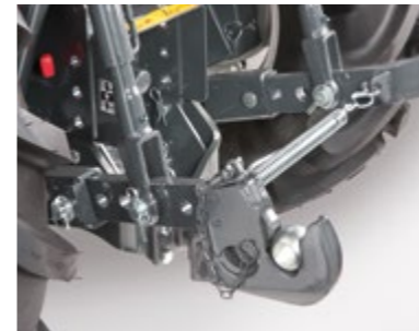
VERSTELLBAREN 3-Punkt-Kupplung hinten mit verstellbaren Unterlenkern und Schnellkupplungen.
