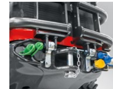
VORDERE SCHNELLANSCHLÜSSE Vorderer Kraftheber > 6 gleiche Anschlüsse wie hinten, davon 2 doppelwirkende + 1 mit elektronisch geregelter Dauerzuluft und 1 einfachwirkender.
