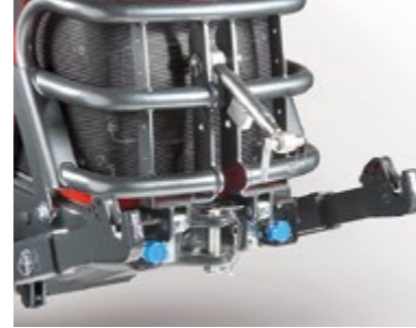
KRAFTHEBER VORDERER Ermöglicht in Zusammenarbeit mit der Bullbar und 1 DW Steuerventile, die Verwendung aller Frontgeräte.
