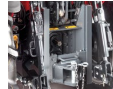
SLIDER-ZUGHAKEN Er ist in den hinteren Kraftheber eingelassen und kann in verschiedene Positionen zur korrekten Ausrichtung der gezogenen Anbaugeräte verstellt werden.
