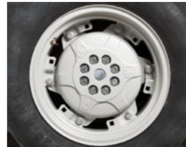
FLANSCHEN AUS GUSSEISEN HINTEN Flanschen für mehr Gewicht auf den Hinterrädern.
