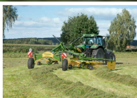
Swadro TS 620 Twin Arbeitsbreite 6,20 m / (2x 3,46 m)
