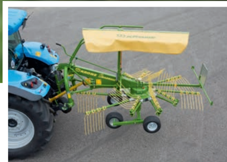
Swadro 35 bzw. 38 und 38 T Arbeitsbreite 3,50 bzw. 3,80 m
