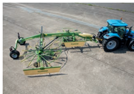
Swadro TS 740 Twin Arbeitsbreite 7,40 m / (2x 4,10 m)
