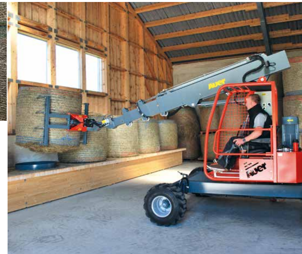
Luftkanal abgewinkelt mit Holzverkleidung Die oberen Ballen werden vorgetrocknet, die unteren Ballen werden fertig getrocknet
