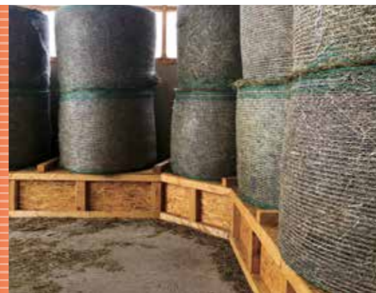
Luftkanal abgewinkelt mit Holzverkleidung Die oberen Ballen werden vorgetrocknet, die unteren Ballen werden fertig getrocknet
