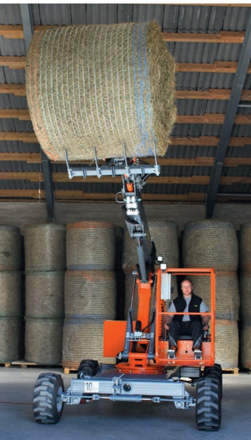
AL130 mit Doppelzylinder und 3-fach Telesausschub
