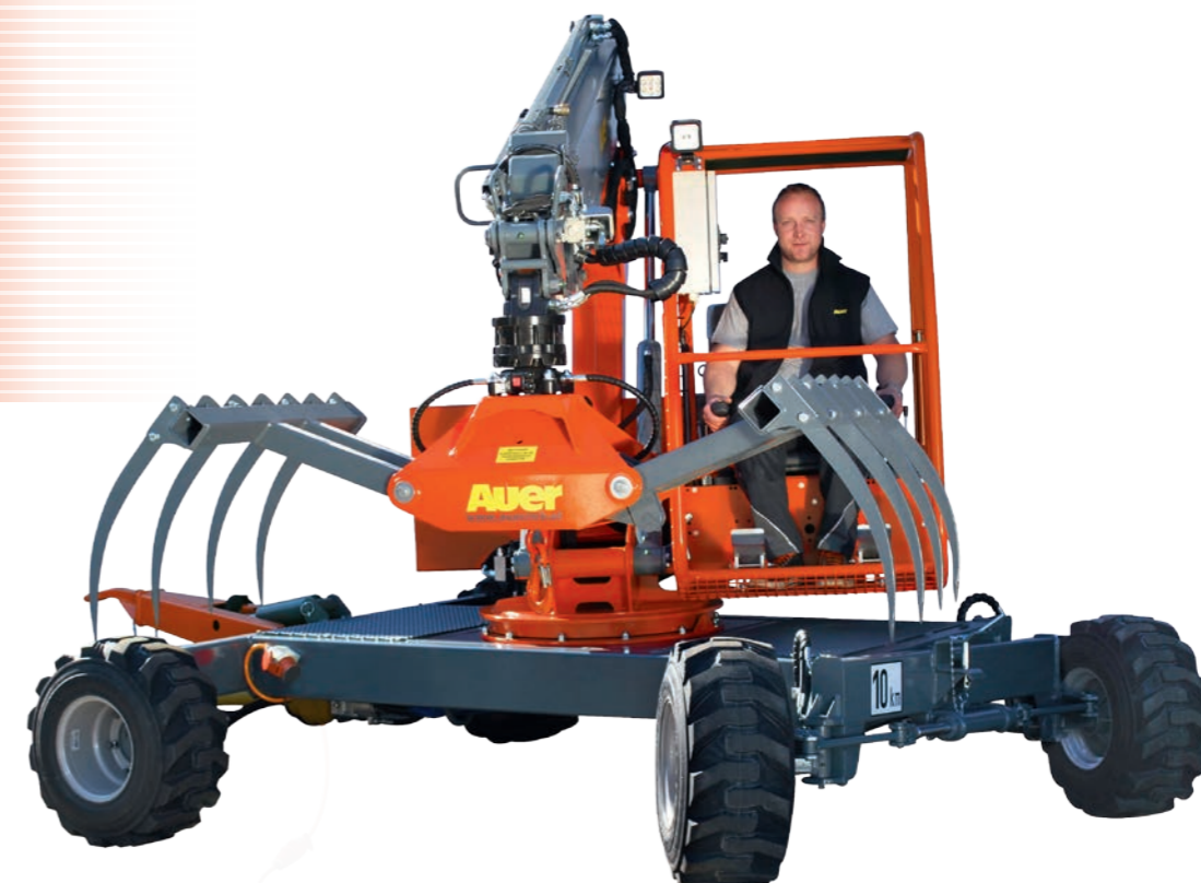
ALZ 130 mit besonders niedriger Bauhöhe und Doppelhubzylinder
