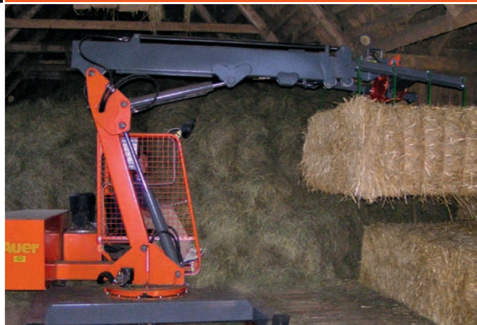
Optimale Lagernutzung mit Mobilkran auf Schienen
