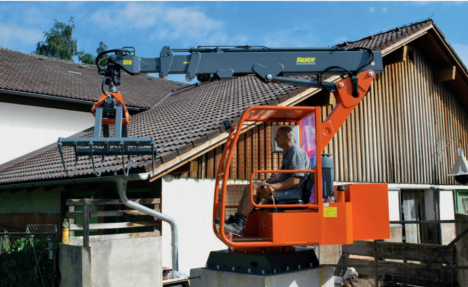
AL 225 mit 2-fach Tele, Rotator mit Welle und Pendelbremse, auf Betonblock stationär montiert
