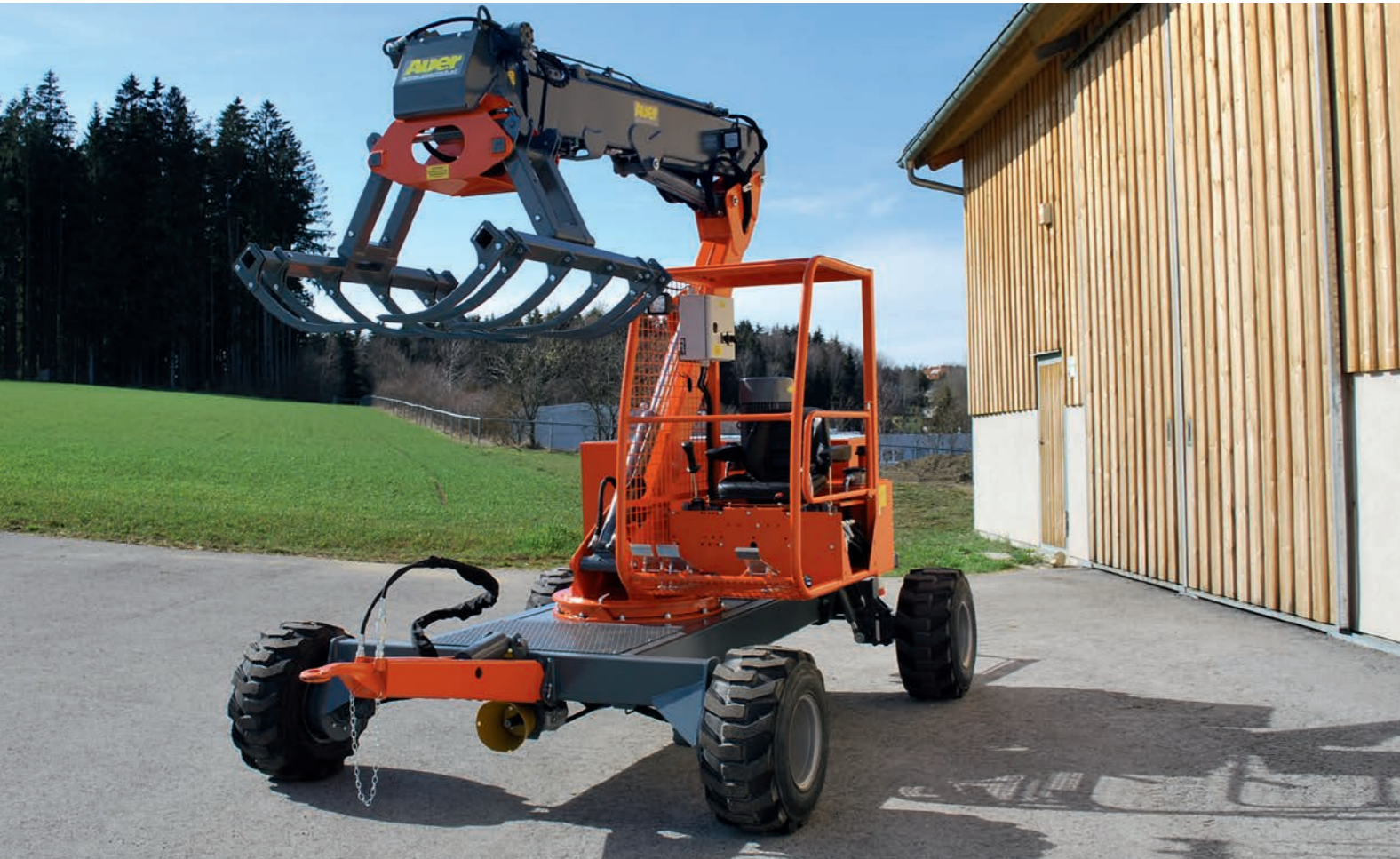
ALZ 225 mit Kettenwinde und hydraulisch höhenverstellbarer Knickdeichsel
