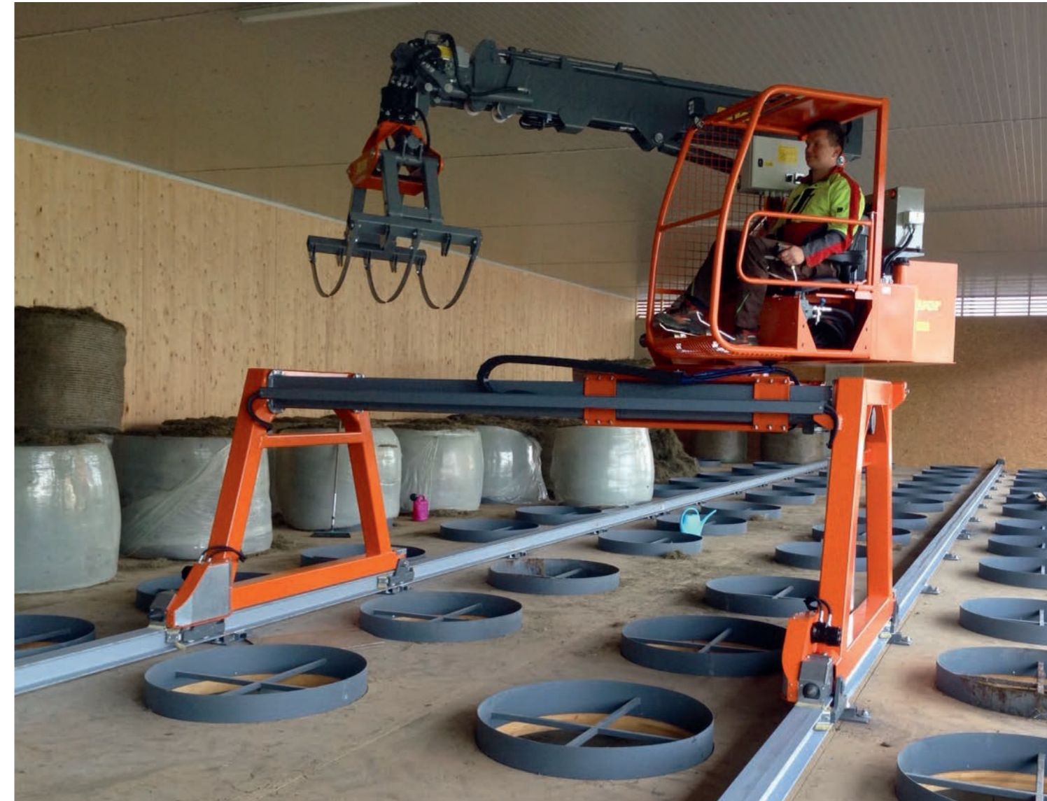
AL165 mit 3-fach Tele, Rotator, Ölkühler, Schienenfahrwerk mit Verschieberahmen und Portalbrücke
