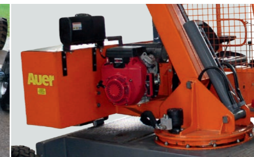
Benzinmotor mit 22 PS und Elektrostarter
