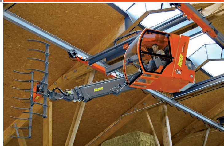
Bei geringer Einbauhöhe ist ein Verschiebegerät die Alternative zum Querfahrwerk
