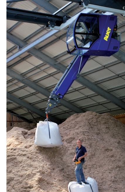
Kransteuerung mittels Joystick in der Kabine oder per Funk
