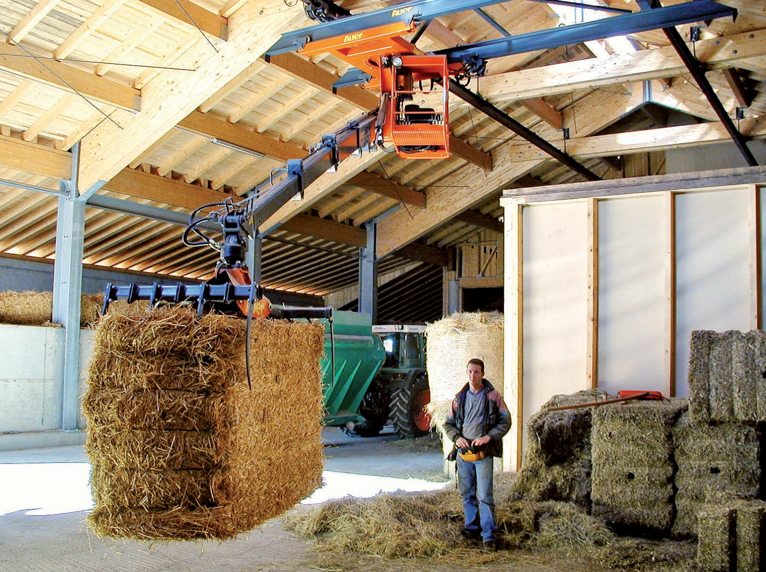
Kran mit Querfahrwerk und Funkfernsteuerung in Proportionalventiltechnik
