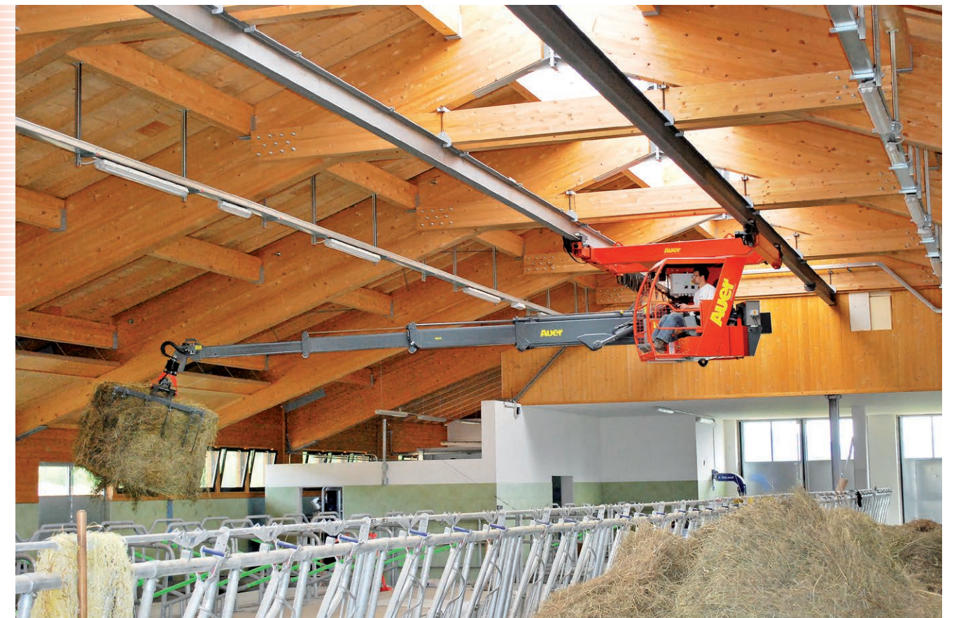
Die Statik des Gebäudes gibt die Hubkraft des Kranes vor
