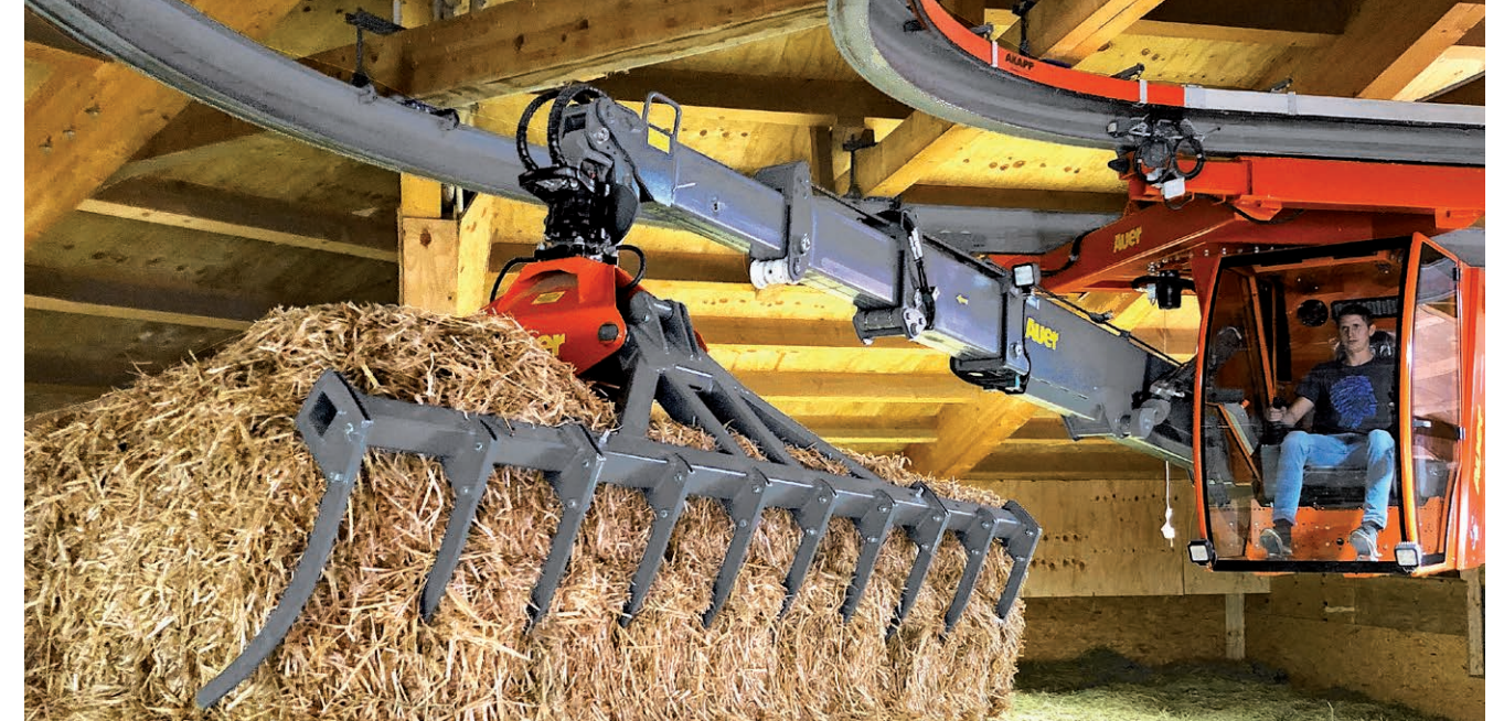
Kurvenbögen werden individuell angefertigt – wie z.B. S-Kurven und geschlossene Kreisbahnen
