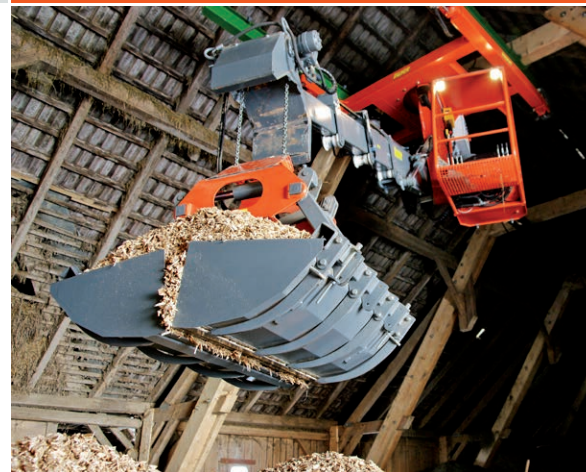
Stufenlos wird die Kettenwinde per Funk gesteuert
