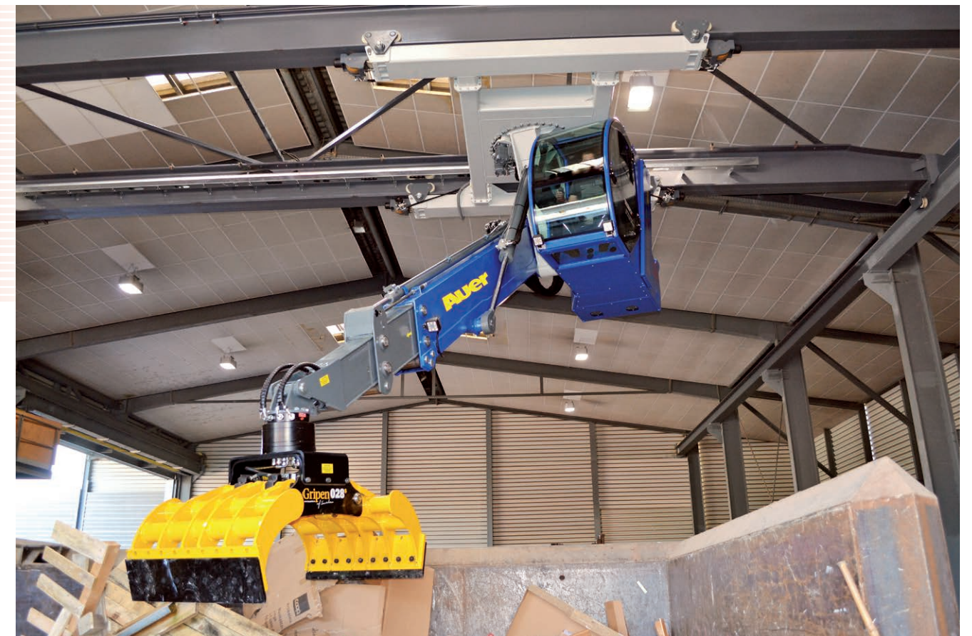
Industriekran zum Sortieren und Verladen von Müll
