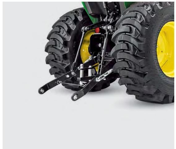
**3-Punkt Heckkraftheber, Kat. 1:** Die hohe Hubkapazität erlaubt den Einsatz unterschiedlichster Anbaugeräte.
