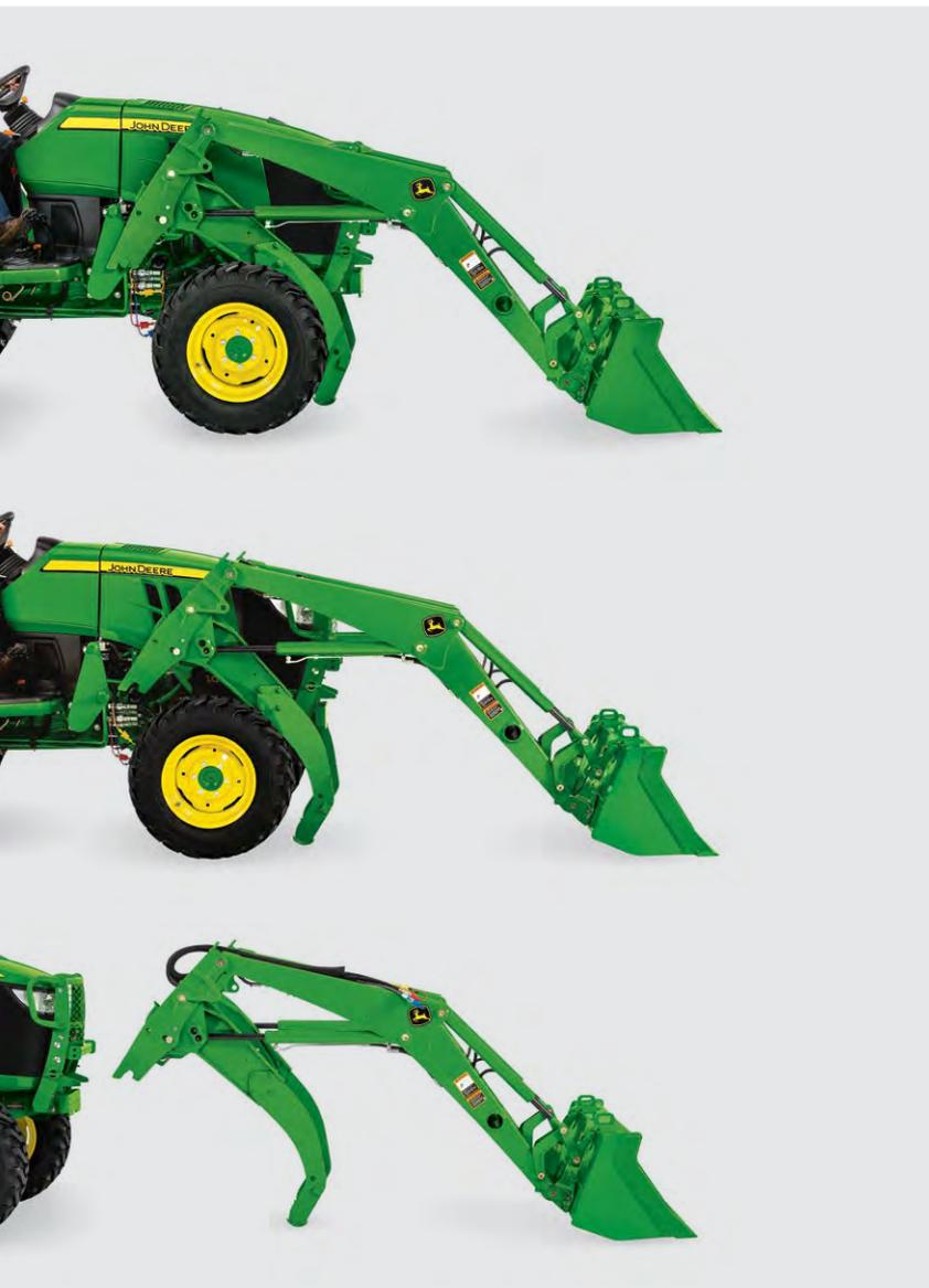
**Frontlader-Schnellanbausystem:** Die Frontlader der Serie R lassen sich schnell, einfach und werkzeuglos an- und abbauen. Die vorne am Traktorrahmen befestigte Abstellstütze bildet mit dem Frontlader während des Frontladerbetriebs eine Einheit. Um den Frontlader abzustellen, brauchen Sie nur die Verriegelungen zu lösen und den Joystick nach oben zu ziehen.
