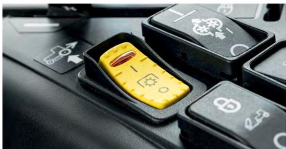
**Unabhängige Zapfwelle:** Durch den Schalter erfolgt die Zuschaltung der Zapfwelle elektrohydraulisch und nicht länger manuell. So können Sie Ihr Anbaugerät während der Fahrt in Betrieb nehmen und arbeiten spürbar schneller und bequemer.
