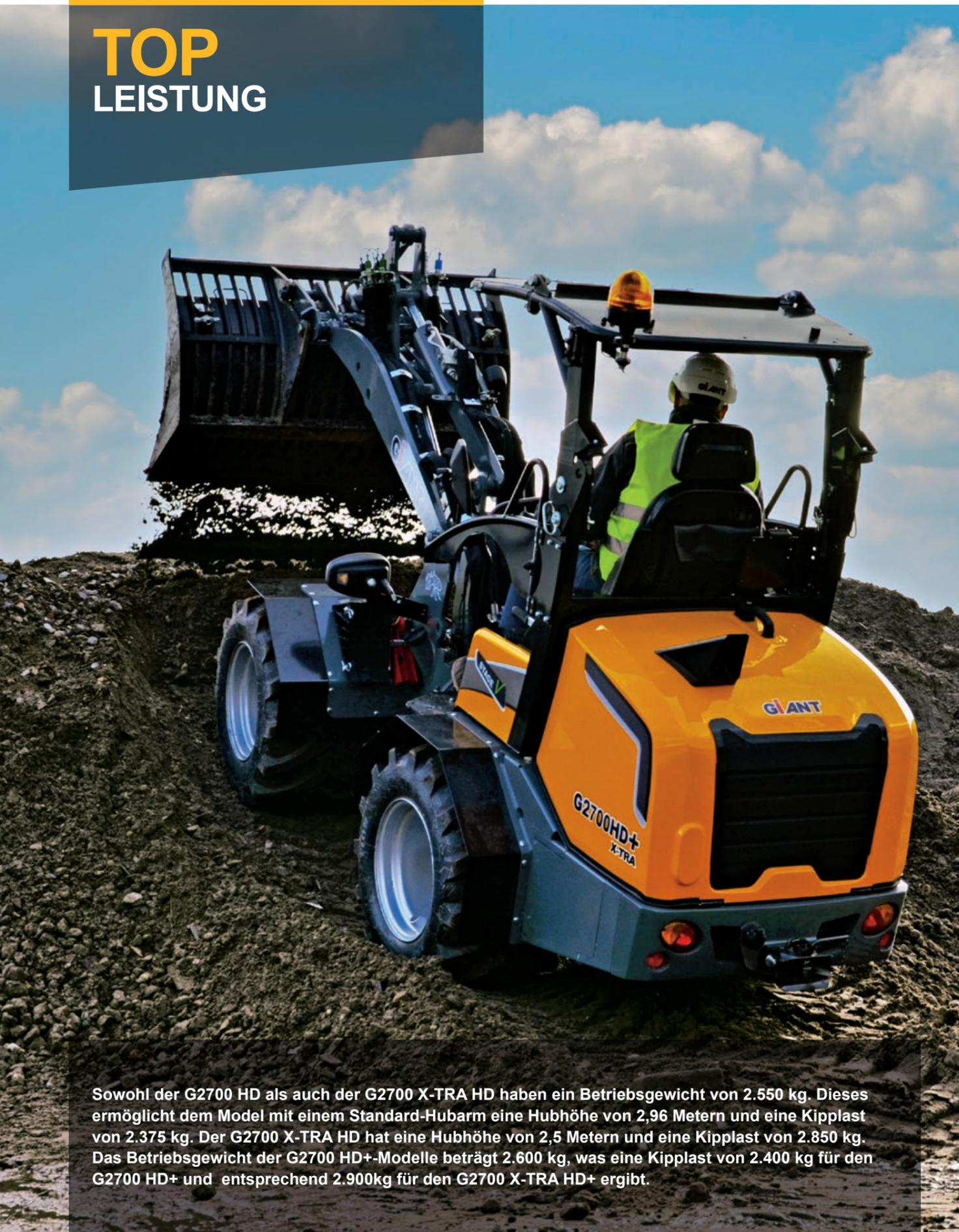
Sowohl der G2700 HD als auch der G2700 X-TRA HD haben ein Betriebsgewicht von 2.550 kg. Dieses ermöglicht dem Model mit einem Standard-Hubarm eine Hubhöhe von 2,96 Metern und eine Kipplast von 2.375 kg. Der G2700 X-TRA HD hat eine Hubhöhe von 2,5 Metern und eine Kipplast von 2.850 kg. Das Betriebsgewicht der G2700 HD+-Modelle beträgt 2.600 kg, was eine Kipplast von 2.400 kg für den G2700 HD+ und entsprechend 2.900kg für den G2700 X-TRA HD+ ergibt.
