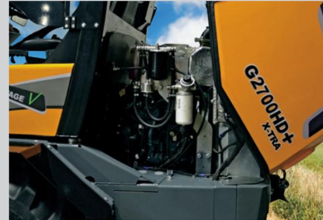
Es ist einfach, die regelmäßig wiederkehrenden Wartungsarbeiten beim G2700 durchzuführen, da die Wartungspunkte gut erreichbar sind. Filter, Hydrauliksystem und Motor sind aufgrund der leicht zu öffnenden Haube und anderer Wartungskappen direkt zugänglich. Somit wird sichergestellt, dass die täglichen Überprüfungen und Wartungsarbeiten schnell und sicher durchgeführt werden können.
